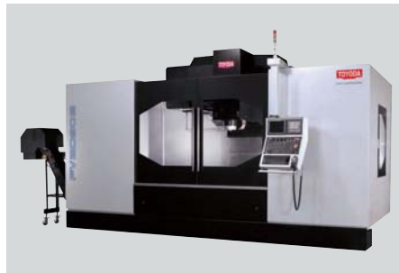
■ Dikey işmilli işleme merkezi FV2090S-i
