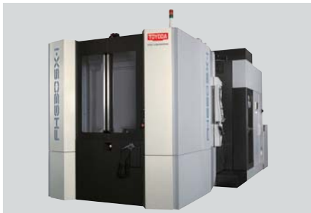
■ Yatay işmilli işleme merkezi FH630SX-i
